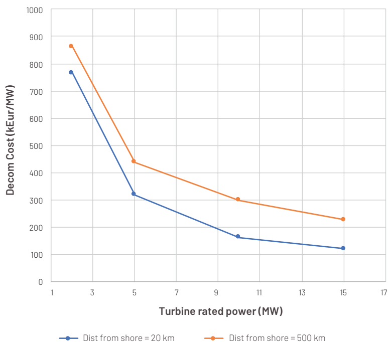
Figuur 14 Decommissioning cost per MW als functie van turbinevermogen (blauw: OWF op 20 km; oranje: OWF op 500 km)
